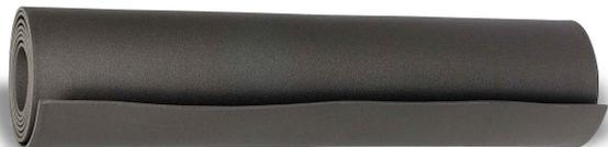
**Poly** è un materassino in polietilene fine a celle chiuse reticolato fisicamente che garantisce il corretto comportamento elastico in applicazioni sottopavimento destinate al miglioramento del confort abitativo. **Poly** può essere applicato quale singolo strato resiliente sottocaldana quando il tecnico competente ne abbia verificato l'idoneità prestazionale per l'applicazione specifica in relazione al carico di esercizio ed alla tipologia di struttura.
