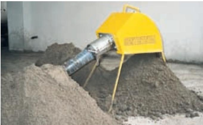
Il sistema é in grado di trasportare numerosi tipi di materiali umidi o asciutti: malte magre, fibrorinforzate, alleggerite, argilla espansa, sabbia, calcestruzzi non strutturali con granulometria fino a 30 mm in base al diametro di tubazione adottata.
