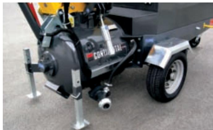
Gli appoggi posteriori telescopici sono regolabili. Il serbatojo a pressione è realizzato con fondi bombati a spessore maggiorato e collettore di scarico rinforzato con camicia intercambiabile.
