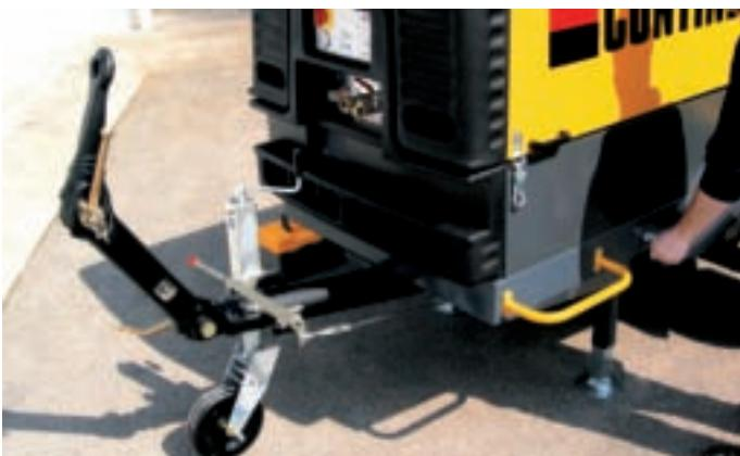
Il solido carrello ammortizzato con freno di stazionamento é dotato di appoggi a martinetto e ruotino di manovra indistruttibile completamente realizzato in acciaio. Il completo quadro di avviamento e monitoraggio del motore é di facile lettura ed ubicato in zona protetta.
